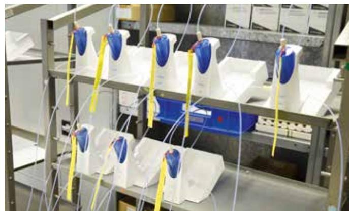
*Alles O.K. Eine Serie TitroLine® Wechselaufsätze nach der Volumenkontrolle.*
