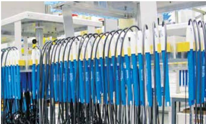
*Sorgfältige Qualitätskontrollen gehören von Anfang an dazu. Bei jeder pH-Elektrode werden Nullpunkt, Steilheit und Einstellzeit geprüft - wie hier bei einer Partie BlueLine Laborelektroden.*
