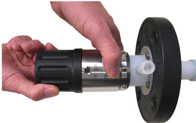
Drücken Sie den Endriegelungsbolzen und drehen Sie den Drehgriff gegen den Uhrzeigersinn bis dieser in der Position „Service“ einrastet.
