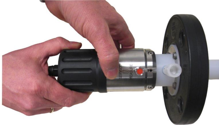
Drücken Sie den Endriegelungsbolzen und drehen Sie den Drehgriff im Uhrzeigersinn bis dieser in der Position „Messen“ einrastet.
