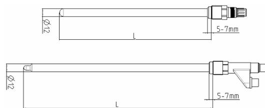
Abb. 8: Gel gefüllter Sensor (oben), flüssiggefüllter Sensor (unten)
