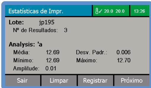
O Método PHR-MEAN, parte integrante dos dois polarímetros Série ADP400, permite que se façam várias leituras diferentes de um lote de amostras, e em seguida é possível imprimir ou armazenar em um arquivo o relatório estatístico, mostrando a média, os resultados altos e baixos, juntamente com o desvio-padrão.
