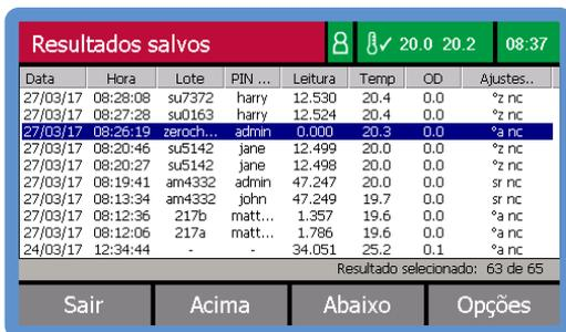
A calibração e configuração podem ser protegidas por senha, acessadas por meio do teclado numérico ou, para maior conveniência, utilizando um cartão de RFID totalmente configurável. Esse recurso, juntamente com a trilha de auditoria, facilita a operação em ambientes em conformidade com o regulamento 21 CFR Parte 11 ou GLP da FDA. Os polarímetros Série ADP400 também são ideais para uso dentro de laboratórios que exigem conformidade com as farmacopeias.
