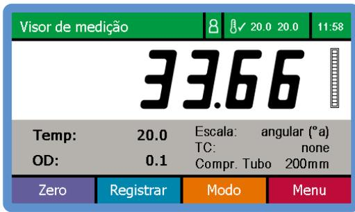
facilitam a exibição de açúcar invertido, inversão (A-B) ou, quando se aplicam outros fatores, como comprimento do tubo e concentração, rotação específica (ou concentração, quando se insere a rotação específica).
