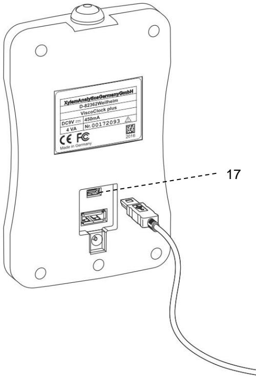
**Abb. 7 Anschluss eines Peripheriegerätes über USB OTG-Kabel VZ 6570 an USB Mini-B Buchse (17) der ViscoClock plus**
