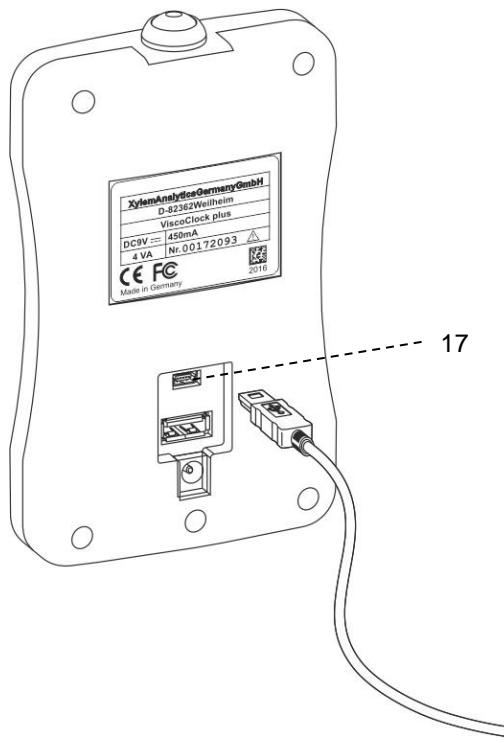
**Fig. 7 Connexion d'un appareil périphérique via le câble OTG USB VZ6570 sur la douille USB Mini-B (17) du ViscoClock plus**
