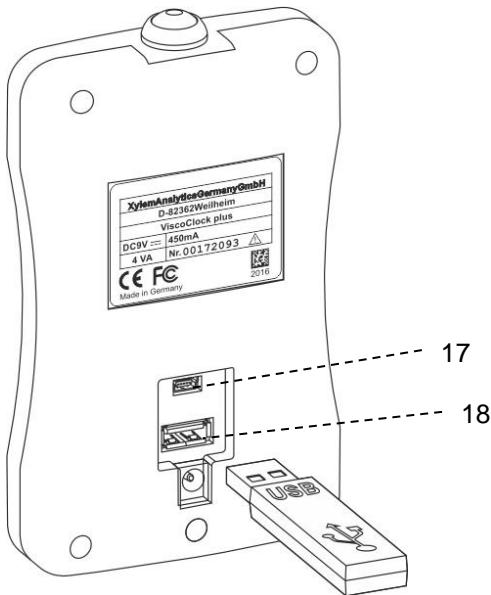
**Abb. 5 Anschluss eines USB-Datenspeichers an die ViscoClock plus**
