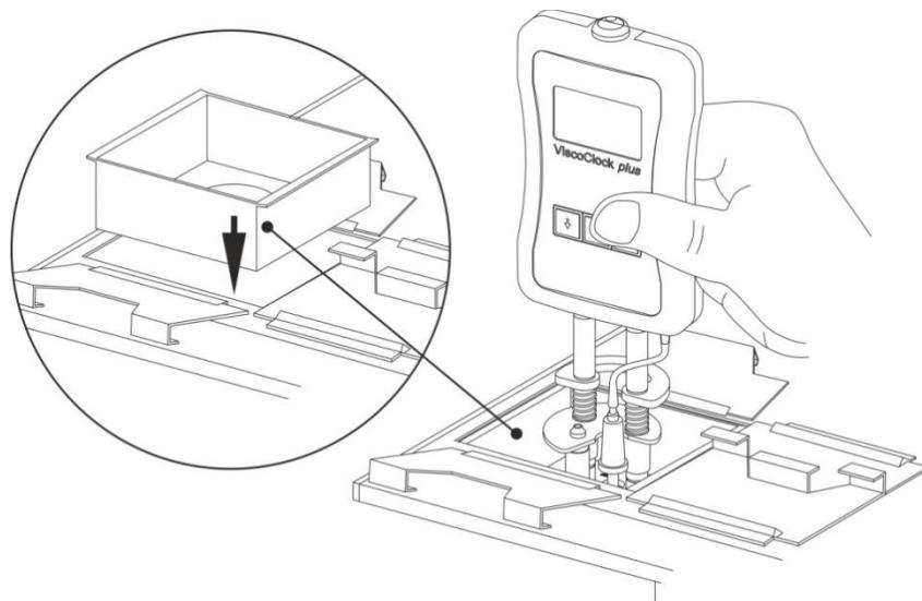
**Fig. 4** Coloque el ViscoClock *plus* el baño termostático.
