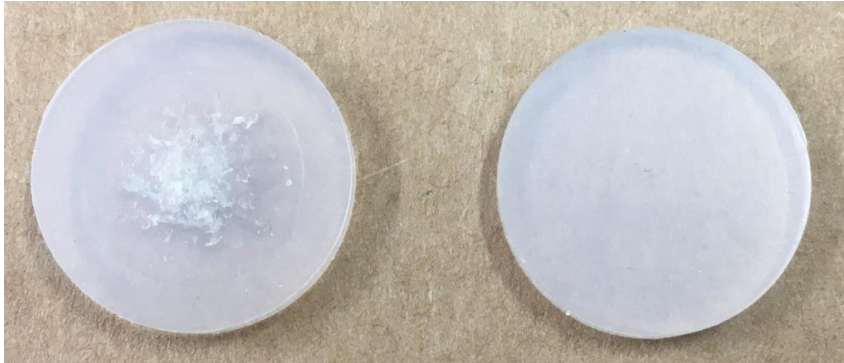
Abb.: Das verschlissene Septum (links) muss ausgetauscht werden.
