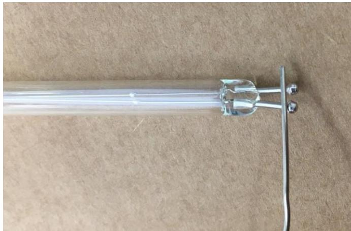
Bleibt die Drift trotz kurzgeschlossener Indikatorelektrode bei ca. 1500  $\mu\text{g}/\text{min}$ , werden die Anschlussstecker der Elektrode mit Aceton oder Isopropanol gereinigt. Bringt dies keine Verbesserung, ist die Elektrode defekt und muss ausgetauscht werden.
