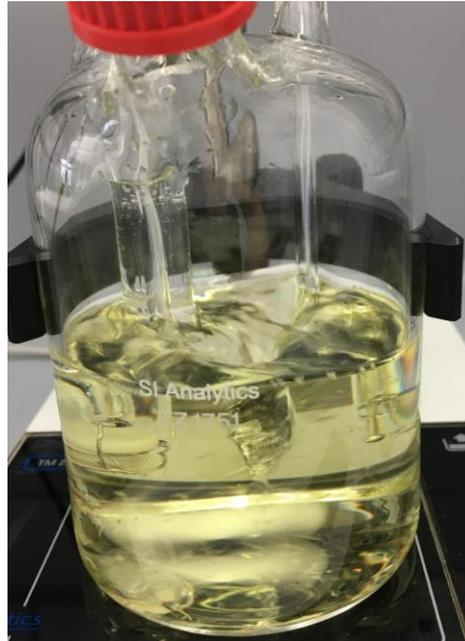
Bei Problemen mit der coulometrischen KF – Titration sollte zuerst ein Wasserstandard (ein Standard mit einer Konzentration von 1 mg/g bietet sich an) titriert werden, um auszuschließen, dass lediglich die Probenmatrix zu Problemen führt.
