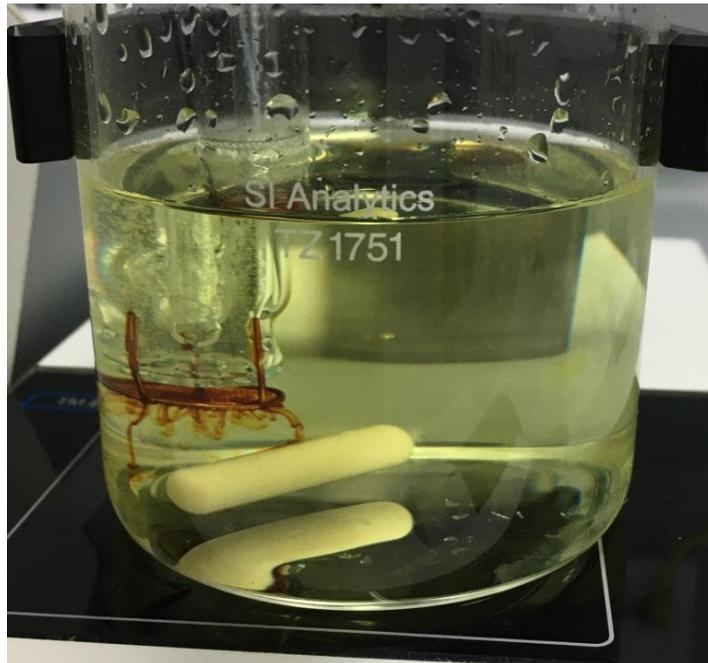
Bilden sich nur wenige Gasbläschen und keine braunen Schlieren, ist die Generatorelektrode oder das Elektrodenkabel defekt und muss ausgetauscht werden.
