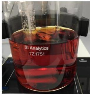
Häufigste Ursachen sind ein verbrauchtes oder ungeeignetes Reagenz, oder eine defekte oder verschmutzte Indikatorelektrode.
