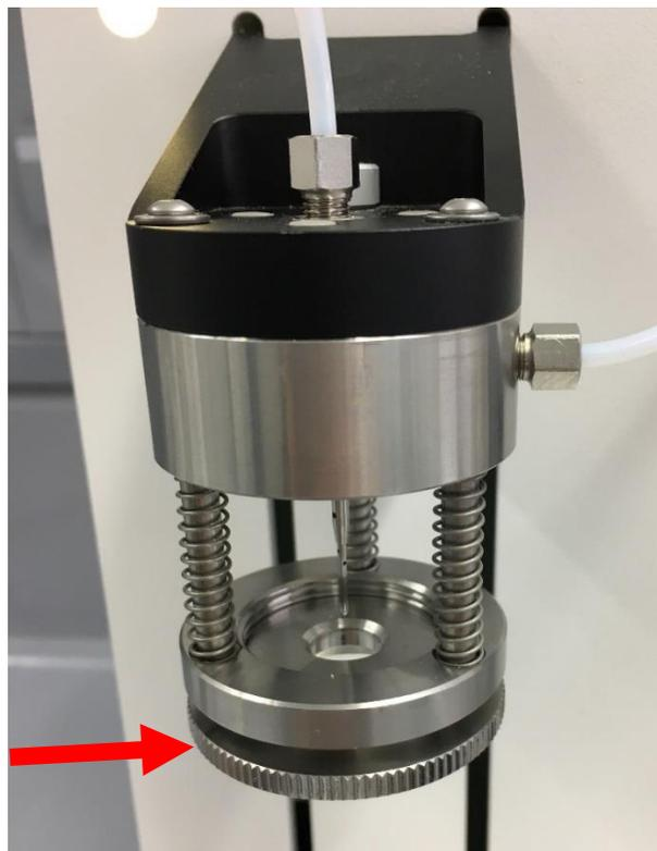
Anschließend kann die Nadel mit dem Nadelschlüssel (Spezialwerkzeug, liegt den Ofen bei) herausgeschraubt werden:
