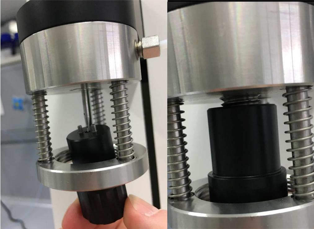
Jetzt kann die Nadel entnommen, geprüft und ggf. gereinigt werden. Die innere Nadel (unten) ist nur durch die äußere Nadel gesteckt.
