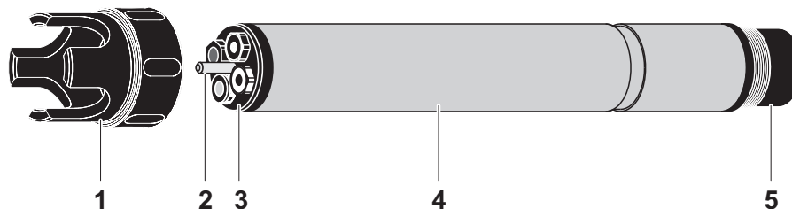
fig. 1-2 Architecture de la sonde VARiON ®Plus 700 IQ
