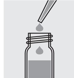
5,0 ml Probe zupipettieren und mischen.
