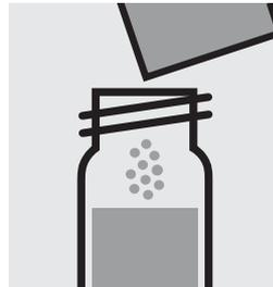
1 Pulverpäckchen **Molybdenum HR2** zugeben, mit Schraubkappe verschließen und Feststoff lösen.
