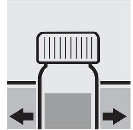
Glas im Wasserbad 5 Minuten bei 40 °C temperieren.
