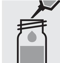
1,0 ml **Ca-1K** mit Pipette zugeben, mit Schraubkappe verschließen und mischen.
