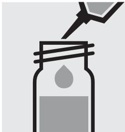
5,0 ml **Isoamylalkohol z. A.** mit Pipette zugeben, mit Schraubkappe verschließen.
