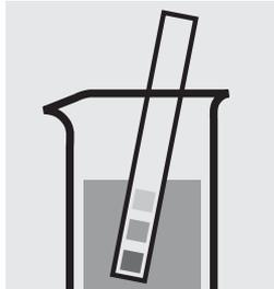
pH-Wert der Probe überprüfen, Soll-Bereich: pH 4–10. Falls erforderlich, tropfenweise mit verdünnter Natronlauge bzw. Salzsäure pH-Wert korrigieren.
