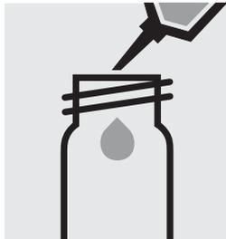
1,0 ml Probe in eine leere Rundküvette (Leerküvetten, Artikel 250621) pipettieren.
