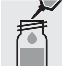
1,0 ml Probe in eine Reaktionsküvette pipetieren, **nicht mischen**.
