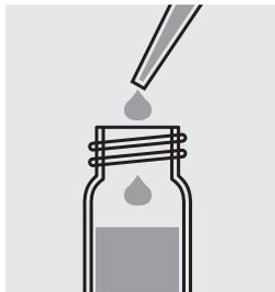
1,0 ml Probe in eine Reaktionsküvette pipettieren und Küvette mit Schraubkappe verschließen.
