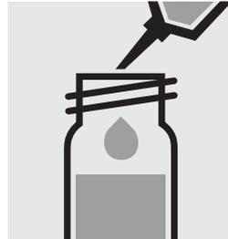
1,0 ml Probe **vorsichtig** in eine Reaktionsküvette pipettieren, mit Schraubkappe fest verschließen und kräftig mischen.
