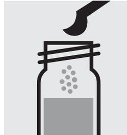
1 gestrichenen grünen Mikrolöffel **CN-3** zugeben, mit Schraubkappe verschließen.
