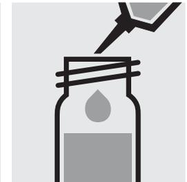
0,50 ml **AC-2** (aus Säurekapazität-Test, Artikel 250087) mit Pipette zugeben, mit Schraubkappe verschließen und mischen.
