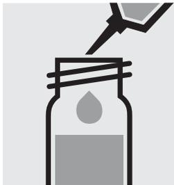
6,0 ml **Au-4** mit Pipette zugeben und mit Schraubkappe verschließen.
