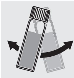
Bodensatz in der Reaktionsküvette durch Schütteln in Schwebel bringen.
