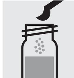
1 gestrichenen blauen Mikrolöffel **NO<sub>3</sub>-1K** zugeben. Küvette **sofort** fest verschließen. **Vorsicht, schäumt stark (Schutzbrille, Handschuhe)!**
