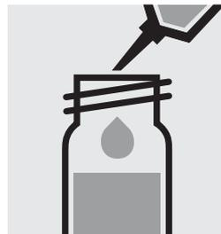
6,0 ml **B-6** mit Pipette zugeben, mit Schraubkappe verschließen und mischen.
