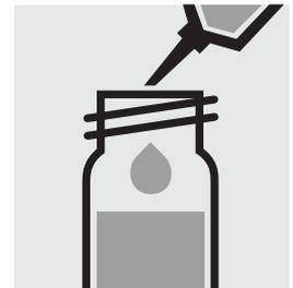
5,0 ml **Zn-6** (Isobutyl methylketon, Artikel 06146) mit Pipette zugeben und mit Schraubkappe verschließen.
