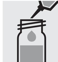
1,5 ml **B-2** mit Pipette zugeben und mit Schraubkappe verschließen.
