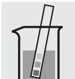
pH-Wert der Probe überprüfen, Soll-Bereich: pH 3–8. Falls erforderlich, tropfenweise mit verdünnter Natronlauge bzw. Schwefelsäure pH-Wert korrigieren.
