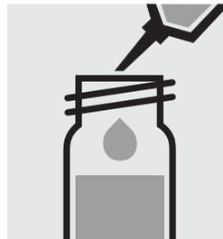
0,50 ml Probe in eine Reaktionsküvette (aus Ammonium-Test, Artikel 250329) pipettieren, mit Schraubkappe verschließen und mischen.
