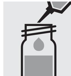
5,0 ml Probe mit Pipette zugeben, mit Schraubkappe verschließen und mischen.
