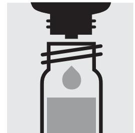
15 Tropfen **B-5** zugeben, mit Schraubkappe verschließen und mischen.
