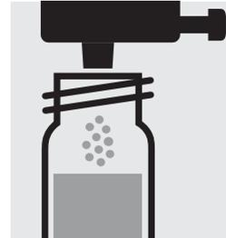
1 Dosis **Cr-2K** mit blauem Dosierer zugeben, mit Schraubkappe verschließen.
