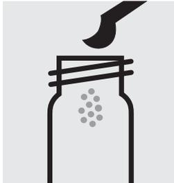
1 gestrichenen blauen Mikrolöffel **NO<sub>3</sub>-1** in eine trockene, leere Rundküvette (Leerküvetten, Artikel 250621) geben.
