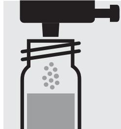
1 Dosis **CN-1** mit grünem Dosierer zugeben, mit Schraubkappe verschließen.
