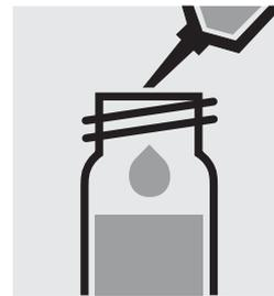
10 ml Probe mit Pipette zugeben, mit Schraubkappe verschließen und mischen.
