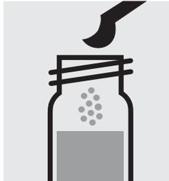
1 gestrichenen blauen Mikrolöffel Cl<sub>2</sub>-1 zugeben, mit Schraubkappe verschließen.
