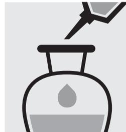
10 ml Chloroform mit Pipette zugeben, Schütteltrichter verschließen.
