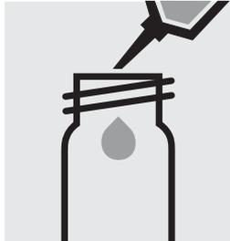
5,0 ml der Probe in eine leere Rundküvette (Leerküvetten, Artikel 250621) pipettieren.
