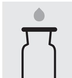
2 Sauerstoff-Reaktionsflaschen mit **angepflichter Nährsalzlösung** und 2 Glasperlen bis zum Überlauf füllen. Mit angeschrägtem Glasstopfen luftblasenfrei verschließen.
