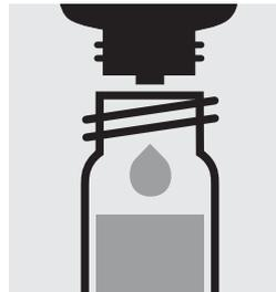
Filtrat mit 4 Tropfen SO<sub>4</sub>-4 versetzen, mit Schraubkappe verschließen und mischen.
