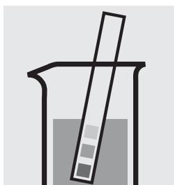
pH-Wert der Probe überprüfen, Soll-Bereich: pH 4–13. Falls erforderlich, tropfenweise mit verdünnter Natronlauge bzw. Schwefelsäure pH-Wert korrigieren.
