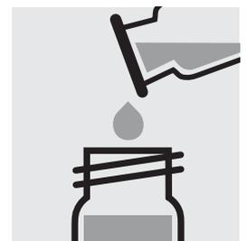
Lösung in eine Rundküvette füllen
