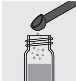
1 gestrichenen schwarzen Messlöffel Nr. 8 **Nitrit 101** zugeben und Küvette mit Schraubkappe verschließen.
