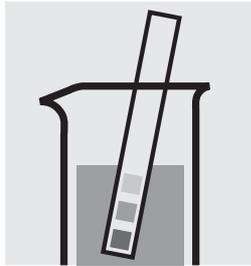
pH-Wert der Probe überprüfen, Soll-Bereich: pH 4–8. Falls erforderlich, tropfenweise mit verdünnter Natronlauge bzw. Schwefelsäure pH-Wert korrigieren.
