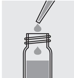
0,5 ml **VARIO Hydra2 Reagent Solution** zupipettieren und Küvette mit Schraubkappe verschließen.
