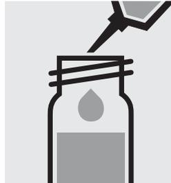
1,0 ml Probe mit Pipette zugeben, mit Schraubkappe verschließen und mischen.
