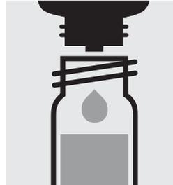
5 Tropfen **Cu-1K** zugeben, mit Schraubkappe verschließen und mischen.
