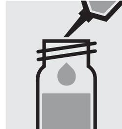
10 ml dest. Wasser in eine zweite Reaktionsküvette pipettieren, mit Schraubkappe verschließen und mischen. (Blindwert)
