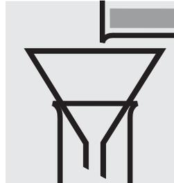
Rückstand mit wenig dest. Wasser in einen 20-ml-Messkolben überführen
