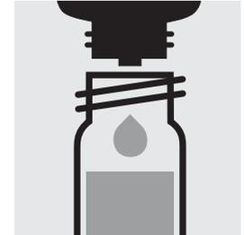
2 Tropfen **Reagenz 1** zugeben, mit Schraubkappe verschließen und mischen.
