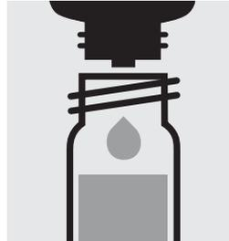
4 Tropfen **pH-1** zugeben, mit Schraubkappe verschließen und mischen. **Achtung!** Reagenzflasche zum Dosieren **senkrecht** halten.
