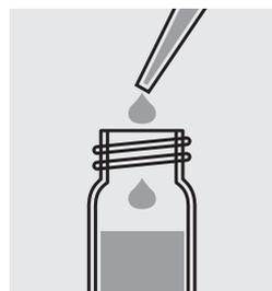
2,0 ml der vorbereiteten Probe in eine Reaktionsküvette **Total Nitrogen Acid HR (Reagent C)** pipettieren und Küvette mit Schraubverschluss verschließen.
