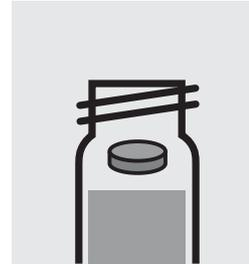
1 Reagenztablette **Cyanuric Acid** zugeben, mit Rührstab zerdrücken und mit Schraubkappe verschließen.
