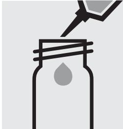
4,0 ml **AC-1** in eine Rundküvette pipettieren.
