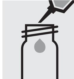
5,0 ml der 1:500 verdünnten Probe in eine leere Rundküvette (Leerküvetten, Artikel 250621) pipettieren.
