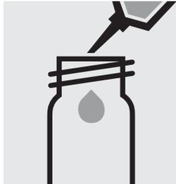
4,0 ml **NO<sub>3</sub>-1** in eine trockene, leere Rundküvette (Leerküvetten, Artikel 250621) pipettieren.
