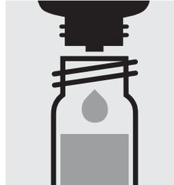
2 Tropfen SO<sub>4</sub>-1 zugeben, mit Schraubkappe verschließen und mischen.
