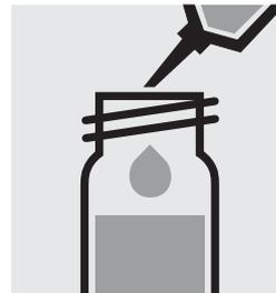
5,0 ml **Isobutymethylketon z. A.** mit Pipette zugeben, mit Schraubkappe verschließen.
