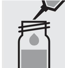
3,0 ml Probe **vorsichtig** in eine Reaktionsküvette pipettieren, mit Schraubkappe fest verschließen und kräftig mischen.
