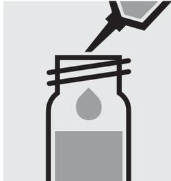
2,0 ml Probe in eine Reaktionsküvette pipettieren, **nicht mischen!**
