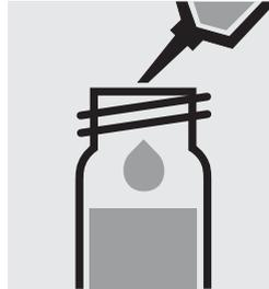
5,0 ml dest. Wasser mit Pipette zugeben, mit Schraubkappe verschließen und mischen.
