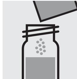
1 Pulverpäckchen **Molybdenum HR1** zugeben, mit Schraubkappe verschließen und Feststoff lösen.
