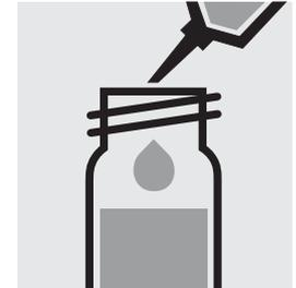
2,0 ml **Probe-Reagenz-Mischung** mit Pipette zugeben, mit Schraubkappe verschließen und mischen.
