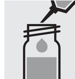
0,50 ml **Reagenz 2** mit Pipette zugeben. Mit Schraubkappe verschließen und mischen.
