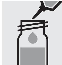
1,0 ml Probe in eine Reaktionsküvette pipetieren, mit Schraubkappe verschließen und mischen.
