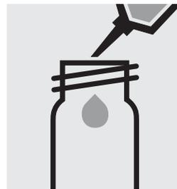
5,0 ml Probe in eine Rundküvette pipettieren.
