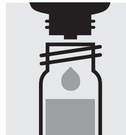
4 Tropfen **B-4** zugeben, mit Schraubkappe verschließen und mischen.
