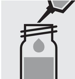
1,0 ml NO<sub>3</sub>-1K in eine Reaktionsküvette pipetieren, **nicht mischen**.
