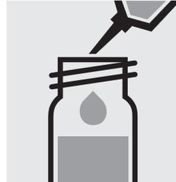
5,0 ml Probe in eine Reaktionsküvette pipettieren.
