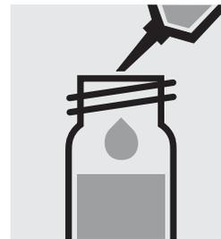
0,20 ml **Oxyscav 2** mit Pipette zugeben, mit Schraubkappe verschließen und mischen.
