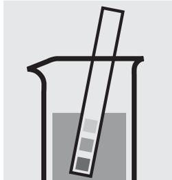
pH-Wert der Probe überprüfen, Soll-Bereich: pH 1–10. Falls erforderlich, tropfenweise mit verdünnter Natronlauge bzw. Salzsäure pH-Wert korrigieren.
