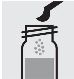
2 gestrichene grüne Mikrolöffel **AOX-6** zugeben, Küvette mit Schraubkappe fest verschließen und mischen.
