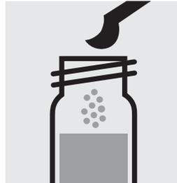
Ca. 1,5 g **Ammoniumchlorid-Hexahydrat reinst.** zugeben, mit Schraubkappe verschließen.
