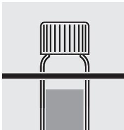
Küvette in den Küvettenständer zurückstellen und **bis auf Raumtemperatur** abkühlen lassen.
