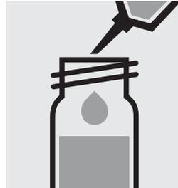
1,0 ml  $\text{NO}_3\text{-1K}$  mit Pipette zugeben, mit Schraubkappe verschließen und mischen. **Vorsicht, Küvette wird heiß!**
