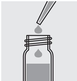
2,0 ml 1,54 N Natriumhydroxid-Lösung zupipettieren, Küvette mit Schraubkappe verschließen und Inhalt durch vorsichtiges Umschwenken mischen.
