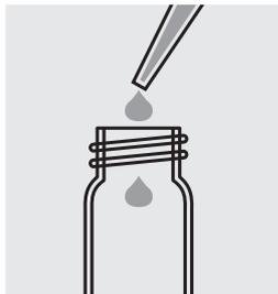
10,0 ml Probe in die leere Küvette pipettieren.
