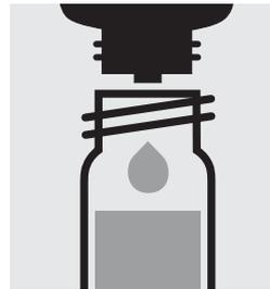
6 Tropfen **Au-5** zugeben, mit Schraubkappe verschließen.
