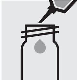
5,0 ml NO<sub>3</sub>-1 in eine trockene, leere Rundküvette (Leerküvetten, Artikel 250621) pipetieren.
