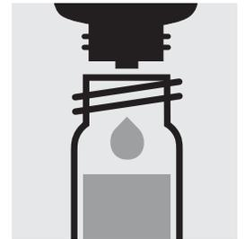
1 Tropfen **Ag-4** zugeben, mit Schraubkappe verschließen und mischen.
