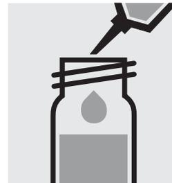
5,0 ml **vorbereitete Probe** mit Pipette zugeben, mit Schraubkappe verschließen und mischen.
