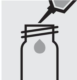
4,0 ml der Probe in eine leere Rundküvette (Leerküvetten, Artikel 250621) pipettieren.
