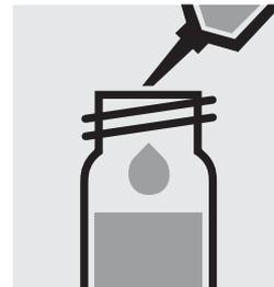
1,5 ml **vorbereitete Probe** mit Pipette sehr langsam zugeben, mit Schraubkappe fest verschließen und kurz mischen.
