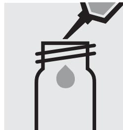
5,0 ml Probe in eine Rundküvette pipettieren.
