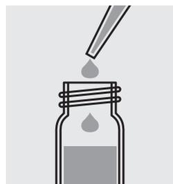
2,0 ml der vorbereiteten Probe in eine Reaktionsküvette **Total Nitrogen Acid LR (Reagent C)** pipettieren und Küvette mit Schraubverschluss verschließen.
