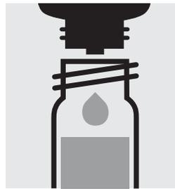
3 Tropfen Cl<sub>2</sub>-2 zugeben, mit Schraubkappe verschließen und mischen.
