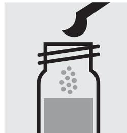
1 gestrichenen gelben Löffel **N-3K** in eine Reaktionsküvette geben, mit Schraubkappe verschließen.
