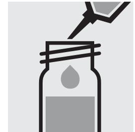
5,0 ml **Toluol z. A.** mit Pipette zugeben, mit Schraubkappe verschließen.
