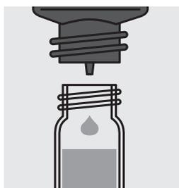
15 Tropfen **VARIO Molybdate 3 Reagent Solution** zugeben und Küvette mit Schraubkappe verschließen.
