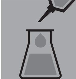
Zur Differenzierung des Chlorophyll-a- und zur Bestimmung des Phaeophytin-a-Gehalts wird ein Teil des Extrakts mit **Salzsäure 2 mol/l z. A.** angesäuert (0,3 ml je 100 ml Extrakt).
