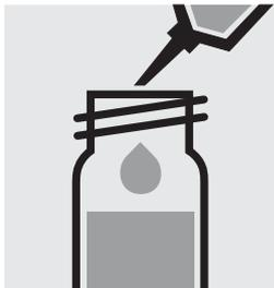
2,5 ml SO<sub>4</sub>-3 mit Pipette zugeben, mit Schraubkappe verschließen und mischen.
