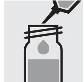
3,0 ml Probe mit Pipette zugeben, mit Schraubkappe verschließen und mischen.
