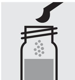
1 gestrichenen grauen Mikrolöffel **Pb-2K** zu der bereits gemessenen Küvette geben, mit Schraubkappe verschließen.
