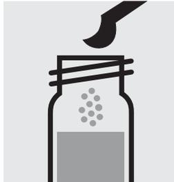
1 gestrichenen gelben Löffel **NO<sub>3</sub>-1K** in eine Reaktionsküvette geben, mit Schraubkappe verschließen.
