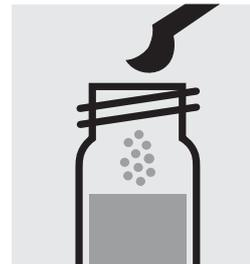
1 gestrichenen grauen Mikrolöffel **Zn-5** zugeben, mit Schraubkappe verschließen und Feststoff lösen.
