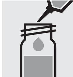
5,0 ml **NO<sub>3</sub>-2** mit Pipette zugeben und mit Schraubkappe verschließen.
