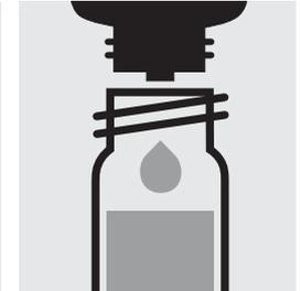
6 Tropfen **K-1K** zugeben, mit Schraubkappe verschließen und mischen.
