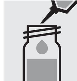
1,0 ml **Phosphorsäure 85 % z. A.** mit Pipette zugeben. Mit Schraubkappe verschließen und mischen.
