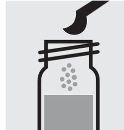
1 gestrichenen grünen Mikrolöffel **Cd-2K** zugeben, mit Schraubkappe verschließen.
