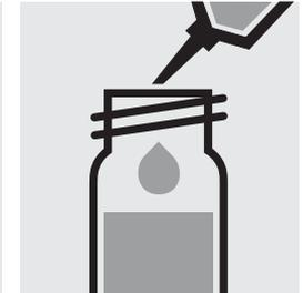
0,20 ml **Reagenz 2** mit Pipette zugeben. Mit Schraubkappe verschließen und mischen.
