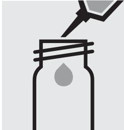
10 ml Probe in eine Rundküvette pipettieren.
