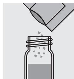
Den Inhalt eines **VARIO Phosphate RGT F10 ml** Pulverpäckchens zugeben und Küvette mit Schraubkappe verschließen.
