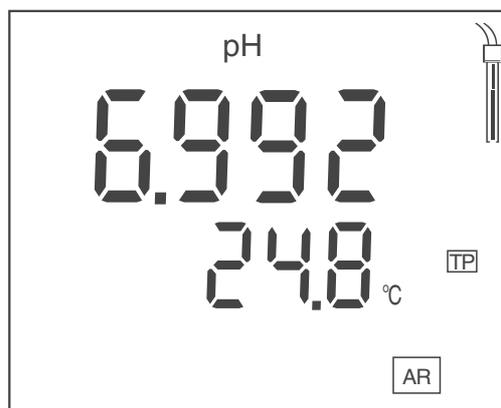
5. Al medir sin sensor térmico: ingresar la temperatura de la solución de medición con **<▲><▼>**.
