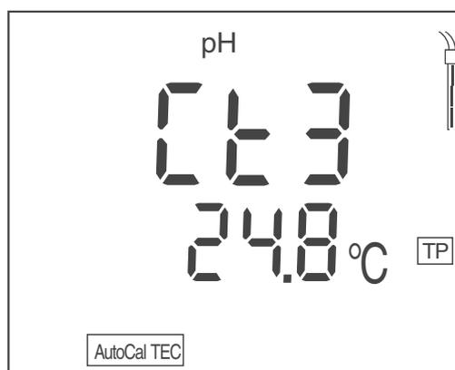
15. En caso dado, finalizar la calibración como calibración de dos puntos con **<M>**.
