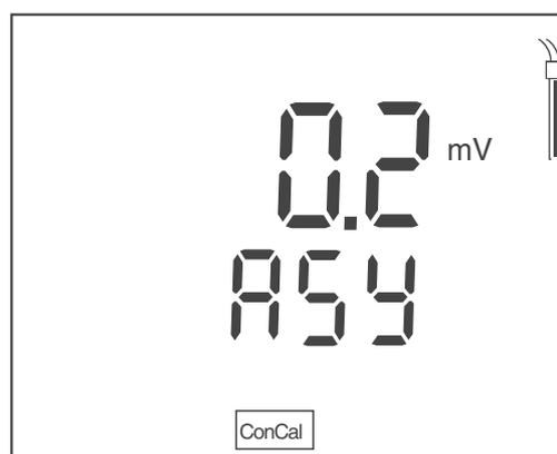
Mientras el punto cero (ASY) esté visible en el display, Ud. puede alternar la indicación de la unidad del punto cero con **<▲><▼>**.
