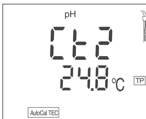
9. En caso dado, finalizar la calibración como calibración de un punto con <M>.
