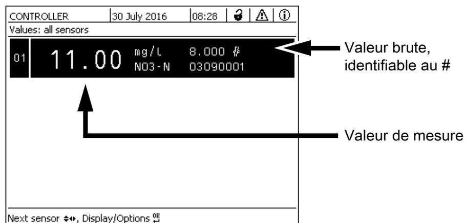
figure 4-2 NitraVis 70x IQ dans l'affichage de la valeur de mesure
