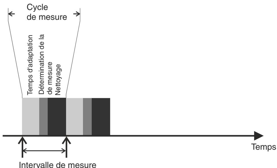
figure 3-6 Cycle de mesure de la sonde
