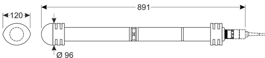
**Poids** env. 3,8 kg (sans protection antichoc, sans câble de raccordement de sonde)
