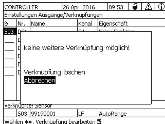
figure 7-14 Paramétrage sorties et liaisons: Effacer liaison
