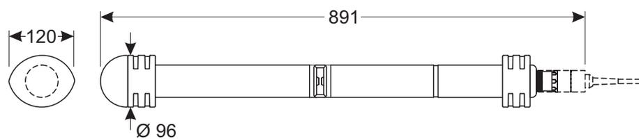
**Gewicht** ca. 3,8 kg (ohne Stoßschutz, ohne Sensoranschlusskabel)
