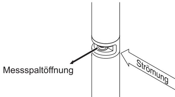
Bild 3-2 Einbau senkrecht
