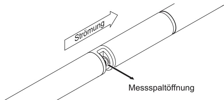
Bild 3-1 Einbau waagerecht
