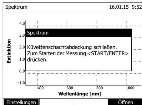
Nach der Aufnahme der Basislinie ist das Photometer messbereit.
