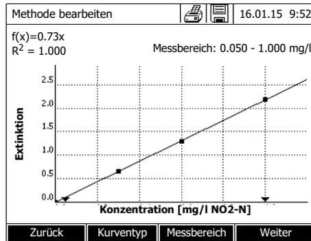
Über dem Diagramm werden die zugehörige Formel  $f(x)$  und der Korrelationskoeffizient  $R^2$  angezeigt.
