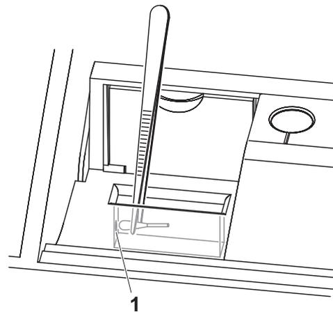
Die Detektorlinse befindet sich auf der linken Stirnseite des Rechteck-Küvetenschachts (Pos. 1).
