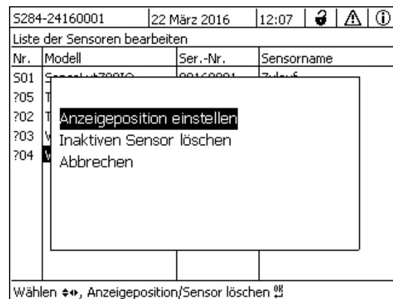
Bild 5-6 Liste der Sensoren bearbeiten -> Inaktiven Sensor löschen
