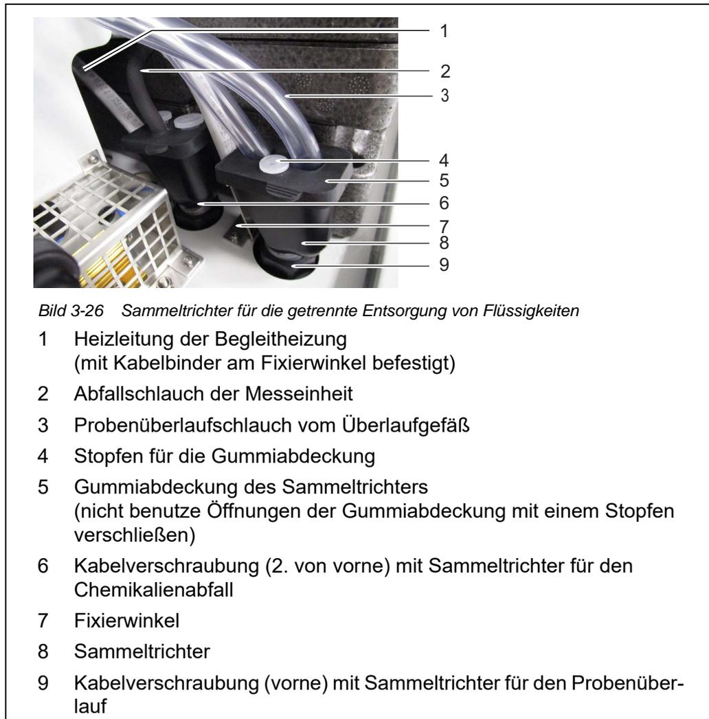
Bild 3-26 Sammeltrichter für die getrennte Entsorgung von Flüssigkeiten
