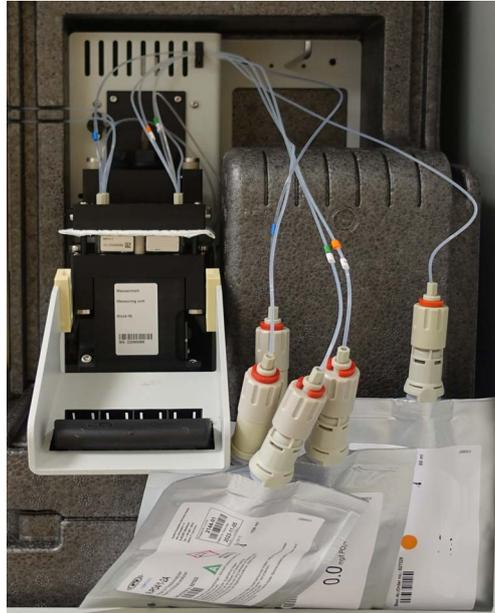
Bild 5-20 Saugfähiges Papier in der Aufnahme des MultiPort Ventils
