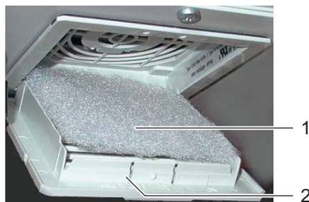
Bild 5-16 Untere Filtermatte wechseln
