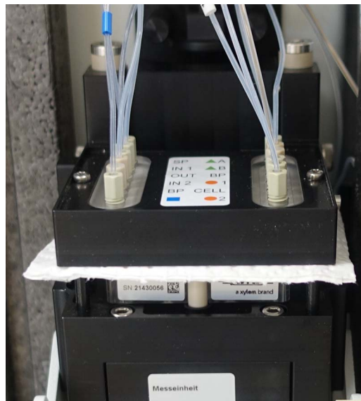
Bild 5-5 Entfernung von Flüssigkeitsresten mit saugfähigem, fusselfreiem Papier
