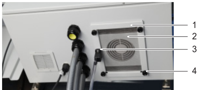
Rysunek 3-18 Zamontowana moskitiera i adapter spustu kondensatu
