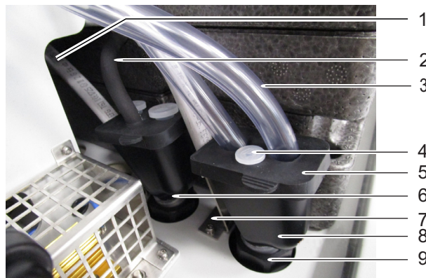
Rysunek 3-26 Lejek zbiorczy do oddzielnego odprowadzenia wszystkich cieczy
