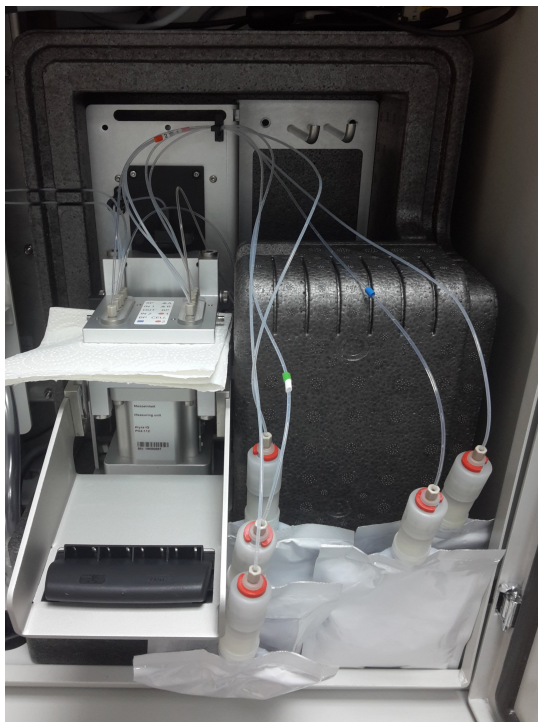
Rysunek 5-20 Papier chłonny w zbiorniku zaworu MultiPort
