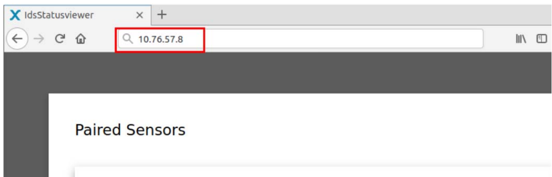
Abb. 3.9 Beispiel: Dem IDS Gate wurde im lokalen Netzwerk die IP-Adresse "http(s)://10.76.57.8" zugewiesen.
