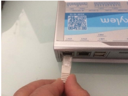
Abb. 3.6 RJ45-Schnittstelle (ETH 1), Verbindung zu einem bestehenden Netzwerk über ein Kabel
