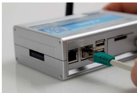
Abb. 3.8 RJ45-Schnittstelle (ETH 0), zur direkten Verbindung mit einem PC über ein Ethernet-Kabel
