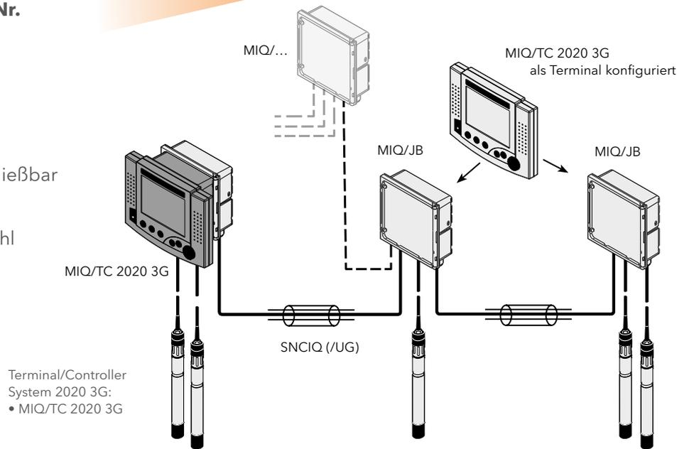
Verzweigtes System 2020 3G für bis zu 20 beliebige Parameter. Beispielsystem mit 6 Analogausgängen; die Messstellen 2 und 3 sind in größerer Entfernung vom Terminal/Controller. Erweiterbar um mobiles Terminal MIQ/TC 2020 3G oder Terminal IQ als zusätzliche Anzeigeeinheit für einfache Vor-Ort-Kalibrierung mit bzw. ohne redundanter Controllerfunktion.
