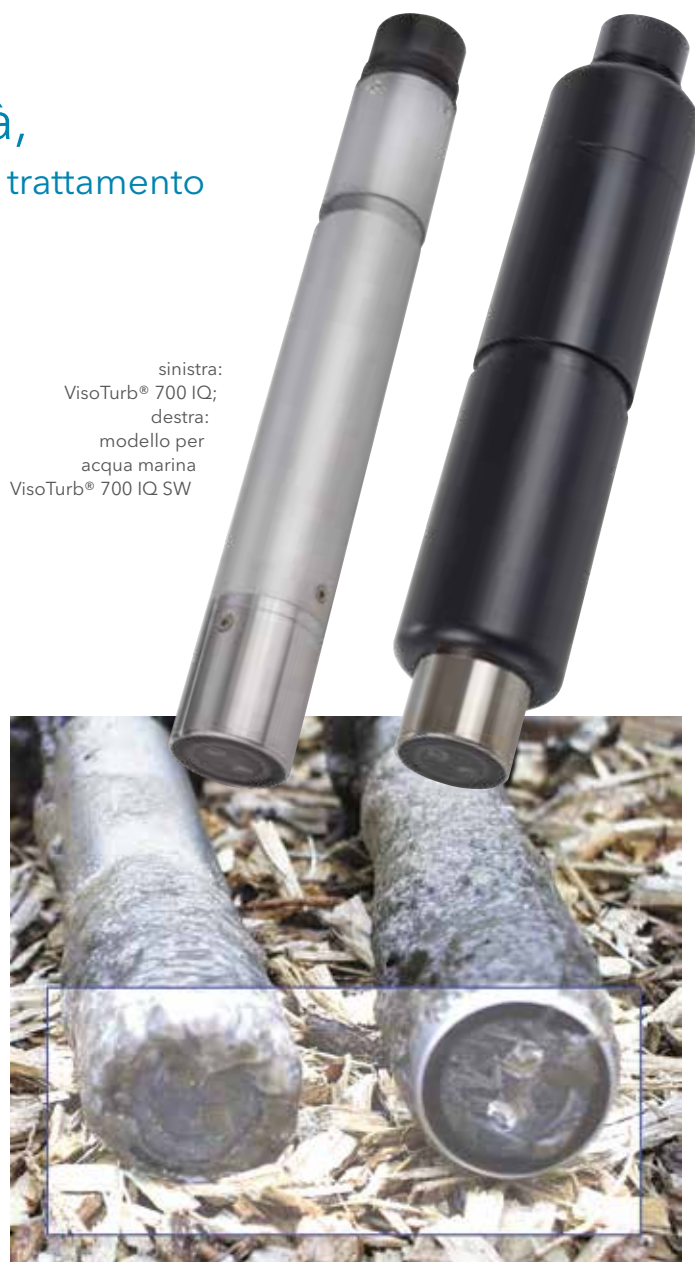
Sensore senza e con sistema di pulizia a ultrasuoni dopo 30 giorni
