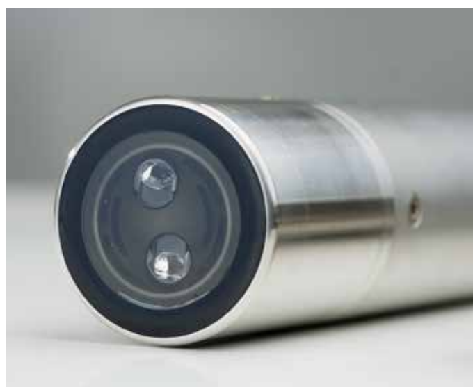
Finestra di misurazione ottica con disco in zaffiro e sistema di pulizia a ultrasuoni
