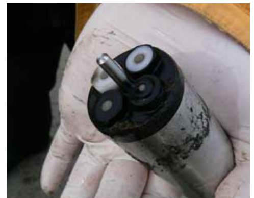
IQ Sensor Net System 2020 und VARiON®-Sensor im Einsatz auf der Kläranlage Glückstadt.
