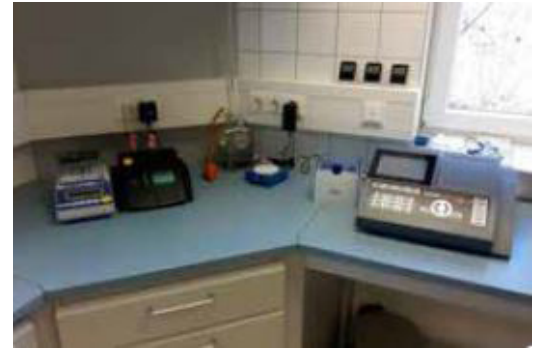
Abb. 3: Photometer photoLab® 7600 UV-VIS zur Messung der optischen reagenzienfreien (OptRF) Methoden im Labor der Kläranlage Peißenberg
