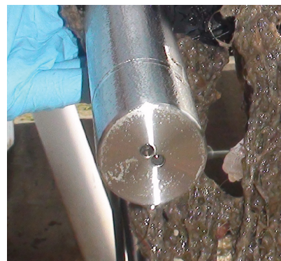
Die Ultraschall-Reinigungstechnologie ist in der Lage, das Biofouling der Sensoren unter sehr rauen Bedingungen zu verhindern, was Zeit und Geld für die Wartung.
