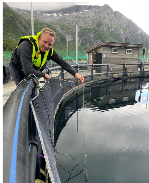
De optiske oksygensensorene fra WTW, henger i merd-kanten med sensorkabel og et avlastningstau.
