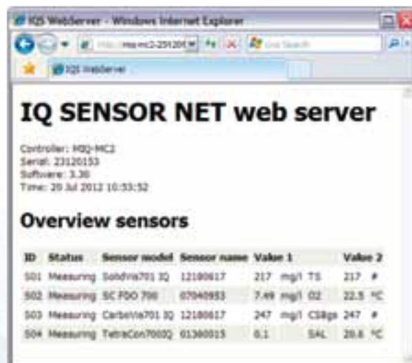
Mit Hilfe eines Webbrowsers angezeigte Messwerte des IQ SENSOR NET-Webserver
