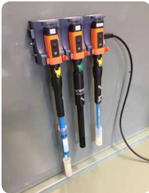
Die WTW-Funksensoren im Labor der Roche-Kläranlage
