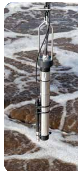
Abbildung 4: Referenzierung eines FDO® 700 IQ Online-Sensors mit einem FDO® 925 Laborsensor
