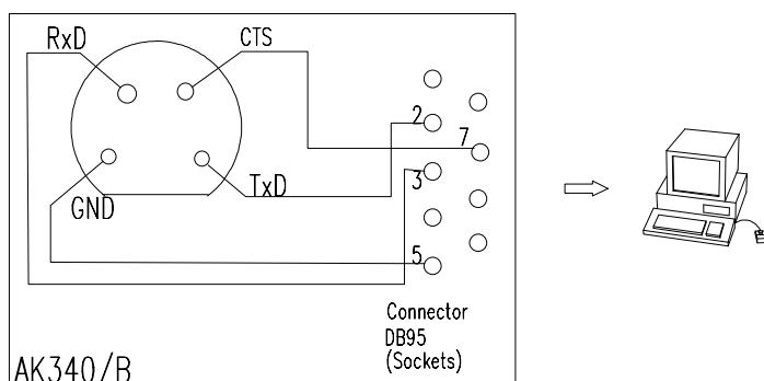
↓ Rechner mit 25pol RS232-Connector werden
