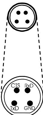
Für MultiLine P3\_P4, Taschengerätreihe '340, 340i, Feldgeräte '197i und inoLab Level2 ist eine Fremdsteuerung über die serielle Schnittstelle vorgesehen. Fremdsteuerung ist nur über das Fremdsteuerkabel AK340/B möglich (nicht über AK325/B).
