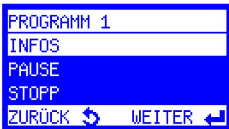
Nach Auswahl von INFOS werden alle Details zum laufenden Programm angezeigt. Die einzelnen Bildschirme können mit den Pfeiltasten auf/ab angezeigt werden.
