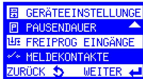
In der Grundausführung steht **1** programmierbarer Eingang zur Verfügung. Mit der Option "I/O Erweiterungsplatine", stehen nochmals **3** weitere Zusatzeingänge zur Verfügung.
