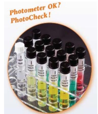
Für Spektralphotometer stehen darüber hinaus zahlreiche Glas- und Flüssigfilter verschiedener Hersteller für Wellenlängengenauigkeit, Streulicht, Reproduzierbarkeit etc. zur Verfügung, die wie im Fall der photoLab® 7000 Serie über entsprechende Menüs unterstützt werden:
