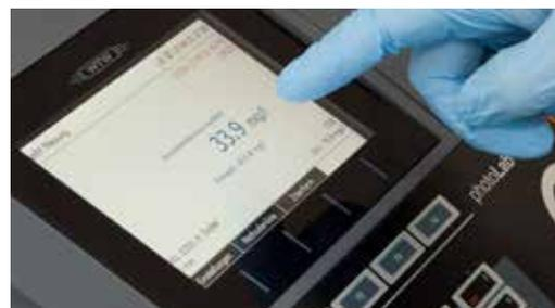
Ergebnis-Anzeigen für die Parameter CSB und Nitrat nach Anwenderkalibrierung mit Ergebnis- und Rohwert
