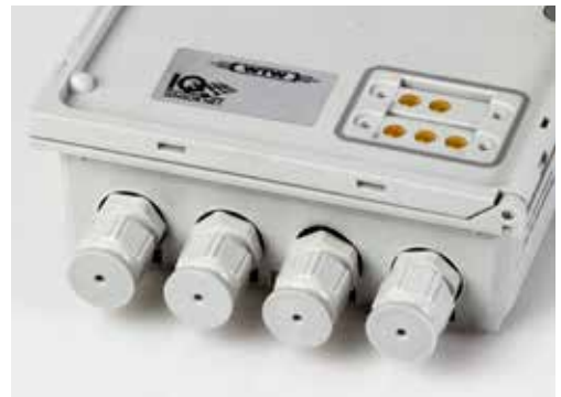
Anschlussleiste der Systemverzweigungs-, analogen Ausgangs-, Eingangs- und Stromversorgungsmodule; mit mindestens zwei freien IQ SENSOR NET-Anschlüssen
