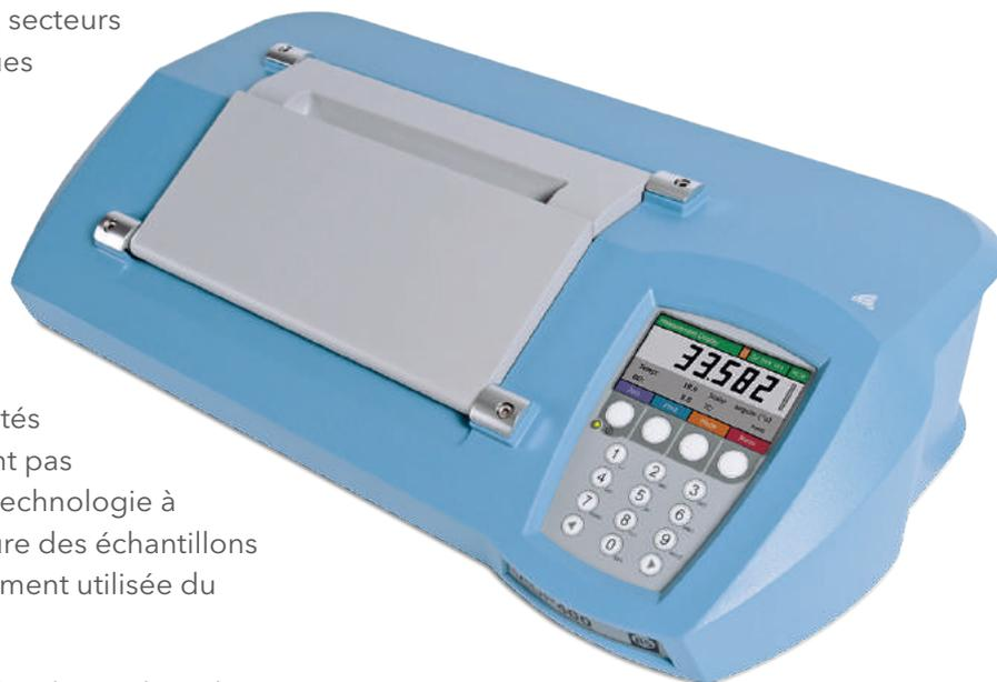
Les polarimètres de la série ADP400 sont dotés d'une source de lumière à LED ne nécessitant pas d'entretien et d'un filtre d'interférence avec technologie à détecteur à photodiode qui assure une lecture des échantillons jusqu'à 3,0 DO à la longueur d'onde couramment utilisée du sodium (589 nm).
