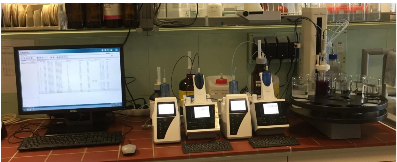
Abbildung 1: Gesamter Aufbau eines Systems zur automatischen Kappa-Zahl Bestimmung
