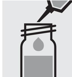
Ajouter 0,20 ml de **RH-1K** à la pipette, fermer avec le bouchon fileté et mélanger.
