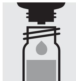
Ajouter 3 gouttes de **H-2K** dans le tube à analyser, fermer avec le bouchon fileté et mélanger.
