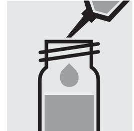
Ajouter 3,0 ml d'échantillon à la pipette, fermer avec le bouchon fileté et mélanger. **Attention, le tube devient brûlant.**
