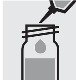
Pipetter 0,50 ml de **CI-1K** dans un tube essai, fermer avec le bouchon fileté et mélanger.
