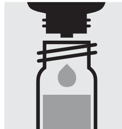
Mélanger le filtrat avec 4 gouttes de  $\text{SO}_4\text{-4}$  et fermer avec le bouchon fileté.
