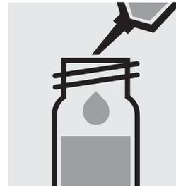
Pipetter 0,50 ml de **Zn-2K** dans le tube à essai, fermer avec le bouchon fileté et mélanger.
