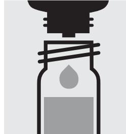
Ajouter 5 gouttes de **PO<sub>4</sub>-1K**, fermer avec le bouchon fileté et mélanger.
