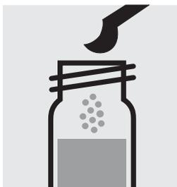
Ajouter 1 microcuiller bleue arasée de **CN-4**, fermer avec le bouchon fileté.
