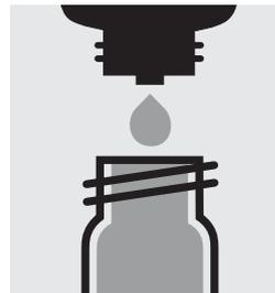
Ajouter 10 gouttes de O<sub>2</sub>-3K, fermer le tube, mélanger et essuyer l'extérieur.
