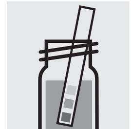
Vérifier le pH de l'échantillon. Résultat nécessaire: pH 6,5. Si nécessaire, ajuster le pH en ajoutant goutte à goutte du sodium hydroxyde en solution ou de l'acide sulfurique dilués.
