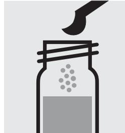
Ajouter 1 microcuvette grise arasée de **Ph-1K**, fermer avec le bouchon fileté.
