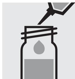
Pipetter 5,0 ml d'échantillon dans un tube avec le bouchon fileté. **(Important: ne pas utiliser de tubes en verre borosilicaté.)**
