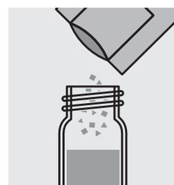
Ajouter le contenu d'un sachet de poudre de **VARIO Sodium Periodate F10** et fermer le tube avec le couvercle fileté.
