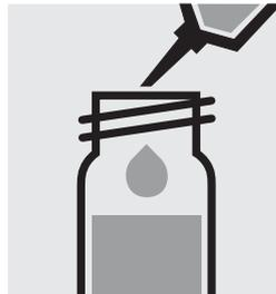
Ajouter **immédiatement** 1,5 ml de  $\text{NO}_3\text{-2}$  à la pipette, fermer avec le bouchon fileté.
