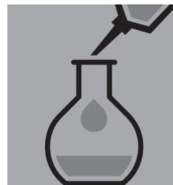
Compléter le ballon jaugé avec d'éthanol, jusqu'au trait de jauge, en opérant à **l'abri de la lumière!**
