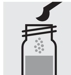
Ajouter 1 microcuiller grise arasée de **Zn-5**, fermer avec le bouchon fileté et dissoudre la substance solide.
