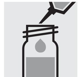
Ajouter 5,0 ml de **Zn-6** (art. 06146, isobutylméthylcétone) à la pipette et fermer avec le bouchon fileté.
