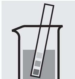
Vérifier le pH de l'échantillon. Domaine nécessaire: pH 3–8. Si nécessaire, ajuster le pH en ajoutant goutte à goutte du sodium hydroxyde en solution ou de l'acide sulfurique dilués.
