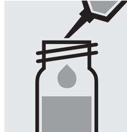
Pipetter 5,0 ml d'échantillon dans un tube à essai, **ne pas mélanger**.
