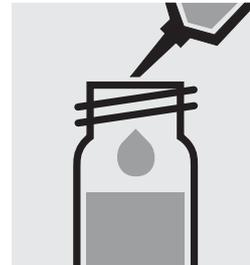
Ajouter 1,0 ml d'**acide phosphorique 85 % pour analyses** à la pipette. Fermer avec le bouchon fileté et mélanger.
