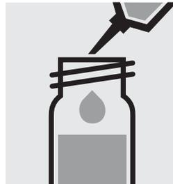
Ajouter 0,50 ml de **NO<sub>3</sub>-2** à la pipette, fermer avec le bouchon fileté et mélanger. **Attention, le tube devient brûlant.**
