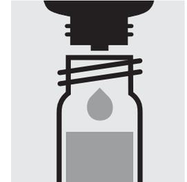
Ajouter 6 gouttes de **K-1K**, fermer avec le bouchon fileté et mélanger.
