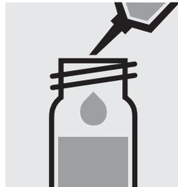
Ajouter 5,0 ml **NO<sub>3</sub>-2** à la pipette et fermer avec le bouchon fileté.
