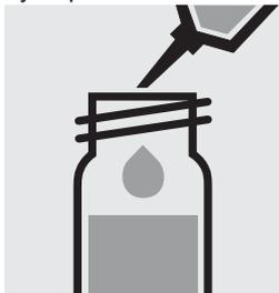
Ajouter 2,5 ml de  $\text{SO}_4\text{-3}$  à la pipette et mélanger.
