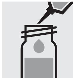
Ajouter 5,0 ml d'**isobutylméthylcétone pour analyses** à la pipette, fermer avec le bouchon fileté et mélanger.
