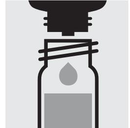
Ajouter 3 gouttes de **Mg-2K**, fermer avec le bouchon fileté et mélanger.
