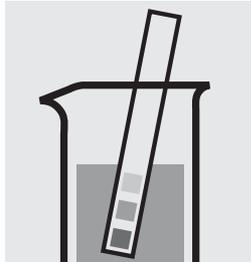
Vérifier le pH de l'échantillon. Domaine nécessaire: pH 3 – 10
