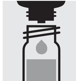
Ajouter 5 gouttes de **Zn-1K** dans un tube à essai, fermer avec le bouchon fileté et mélanger.
