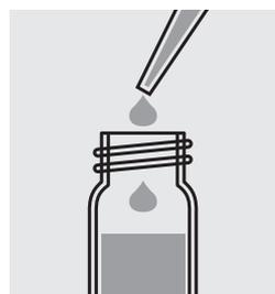
Pipeter 2,0 ml d'échantillon préparé dans un tube à réaction **TN Acid LR/HR (Reagent C)** et fermer le tube avec le couvercle fileté.
