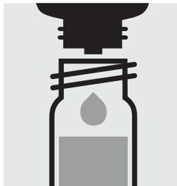
Ajouter 5 gouttes de **Zn-3K**, fermer avec le bouchon fileté et mélanger.
