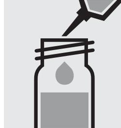
Pipetter 0,50 ml l'échantillon dans un tube à essai (provenant du test Ammonium, art 250329), fermer avec le bouchon fileté et mélanger.
