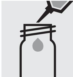
Pipetter 4,0 ml de **NO<sub>3</sub>-1** dans un tube vide (tubes vides, art. 250621) et sèche.
