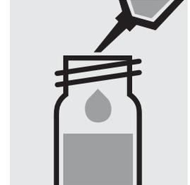
Ajouter 0,50 ml de **AC-2** (provenant du test capacité pour acides, art 252087) à la pipette et mélanger.
