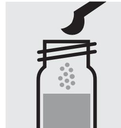
Ajouter 1 microcuiller verte arasée de  $\text{SO}_4\text{-2}$ , fermer avec le bouchon fileté et mélanger.
