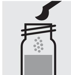
Ajouter 1 microcuiller bleue arasée de **Fe-1K**, fermer avec le bouchon fileté.
