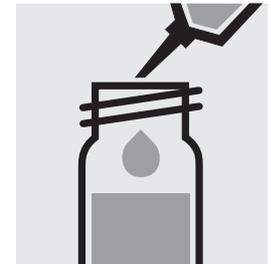
Ajouter 2,0 ml de **mélange échantillon – réactif** à la pipette, fermer avec le bouchon fileté et mélanger.
