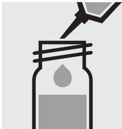
Ajouter à la pipette 6,0 ml de **Au-4** et fermer avec le bouchon fileté.
