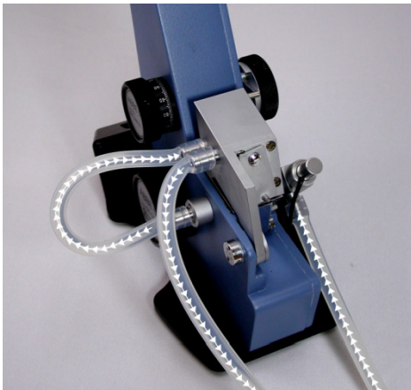
Controle de temperatura de um circulador
