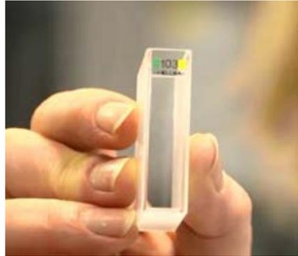
Abb. 3 Küvettenmarkierung
