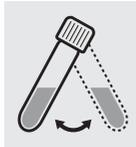
Bodensatz in der Küvette durch Umschwenken in Schwebel bringen.
