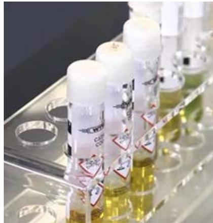
Abb. 2 CSB-Test in Dreifachbestimmung
